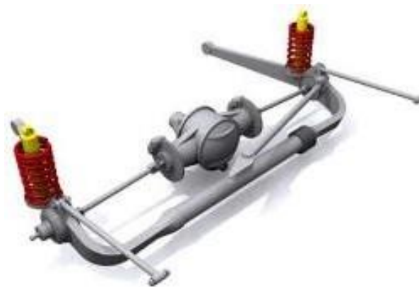
Figura 2.8: Suspensão De Dion (EBAH, 2017).
