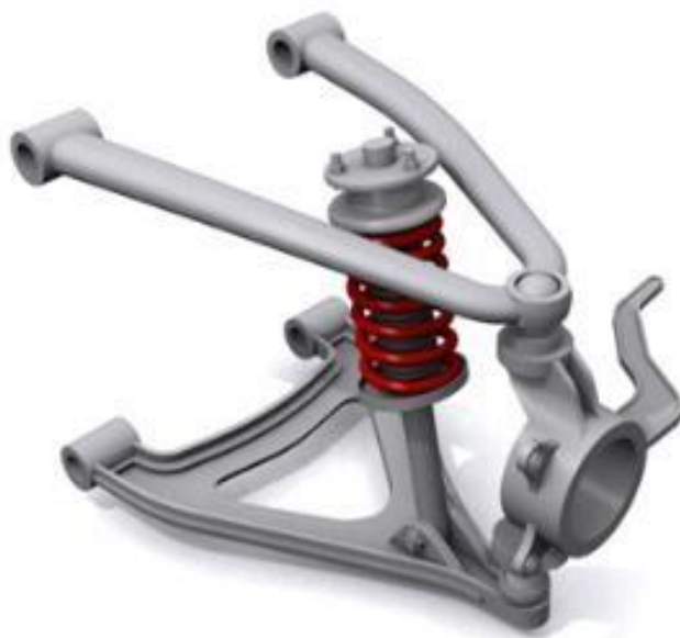
Figura 2.5: Suspensão Duplo A (AMARAL et al. , 2016).
